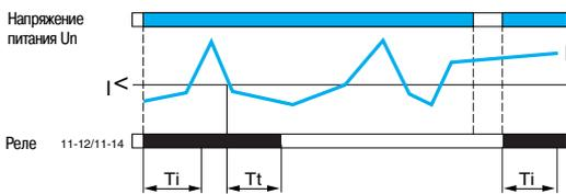
Ti: выдержка времени для исключения ложных срабатываний реле при запуске насоса (повышенный или пониженный ток, выставляется на лицевой панели реле).
