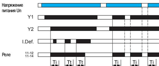
Tl: выдержка времени для исключения ложных срабатываний реле при запуске насоса (повышенный или пониженный ток, выставляется на лицевой панели реле).
